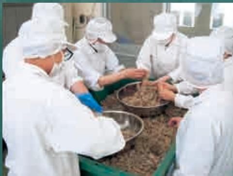
◀ 蒸した米麦に麴菌を添加する作業
