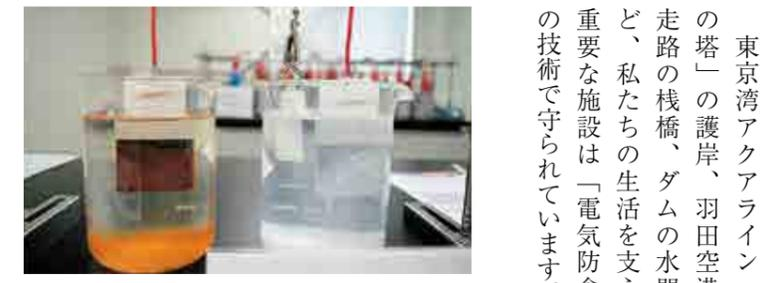
食塩水中に金属を入れた実験。そのままだと錆びるが(左)、電気防食すると金属は錆びない(右)。
