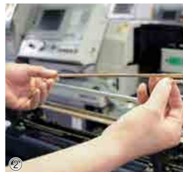
①加工に合わせた機械のパーツ ②③真ちゅう棒から部品を切り出す
